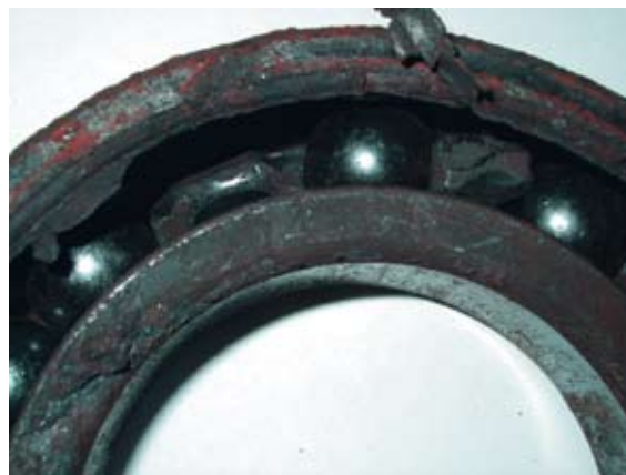
Импортный подшипник, отработавший 6 месяцев в условиях влажности 100%, при давлении 12 атмосфер, 180°C
