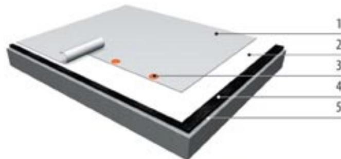
1. Гидроизоляционная мембрана ПЛАСТФОИЛ®
