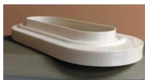
Рис. 7. Макетный образец овальной манжеты с гофрой на плоской стенке, выполненный в масштабе 1:15 методом 3D печати
