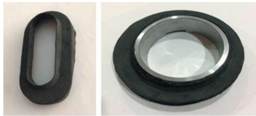
Рис. 6. Макетный образец овальной (вытянутой) манжеты, выполненный в масштабе 1:15 методом 3D печати: а – в свободном состоянии; б – установленный на цилиндрических оправках.
