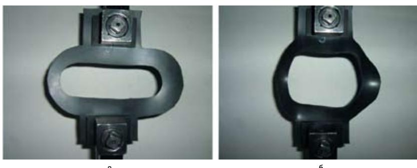
Рис. 4. Овальный замкнутый образец с противоположно расположенным овалами шириной 15 и 30 мм: а – в начальном состоянии; б – в расправленном на 40 мм состоянии.
