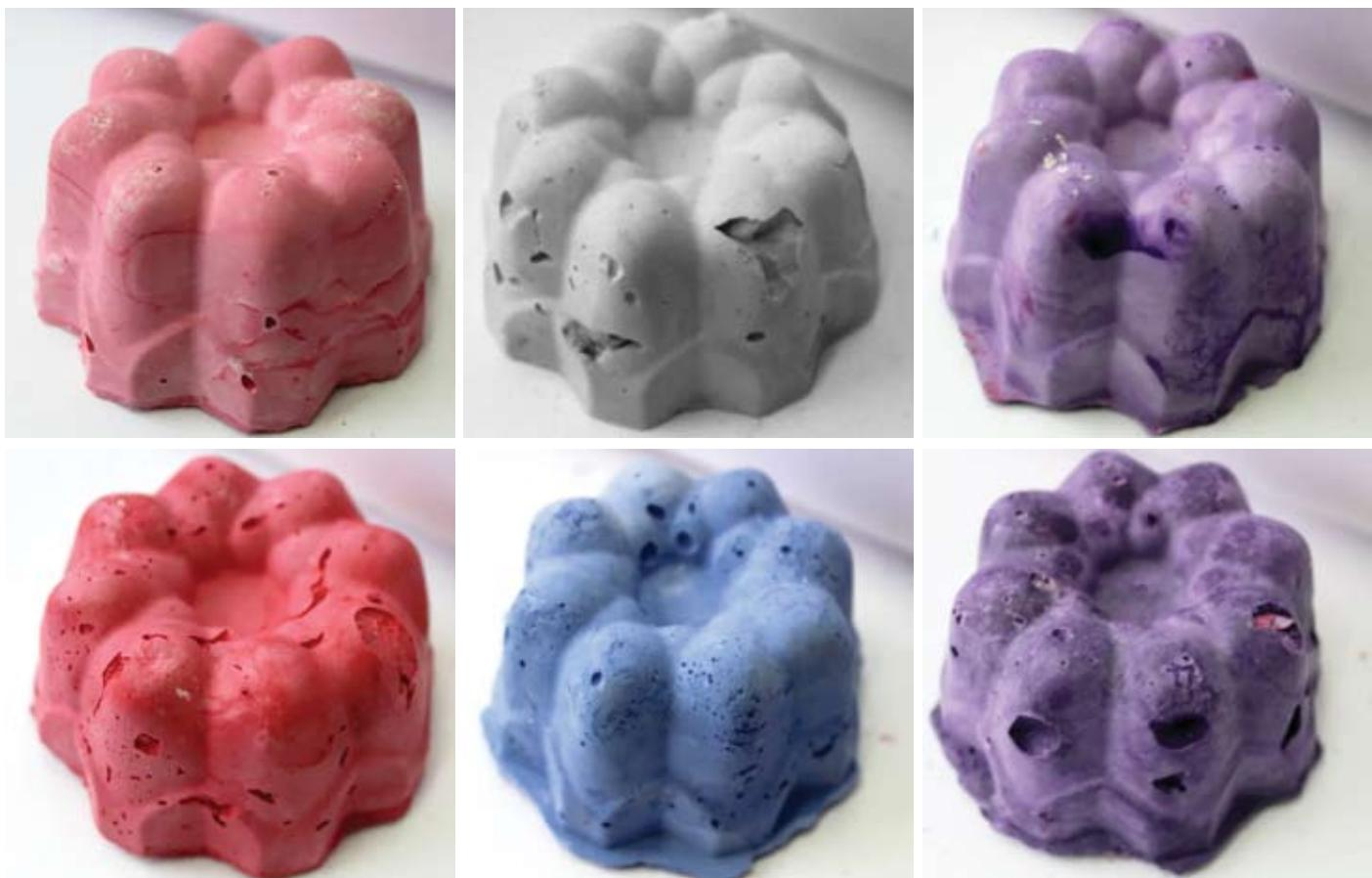
Рис. 3. Внешний вид образцов с минимальным (10%) и максимальным (70%) содержанием колера
