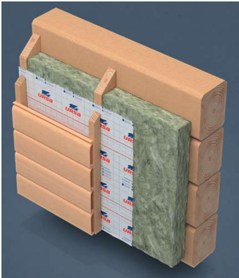
Рис. 1. Конструкция дополнительного утепления наружных стен из бруса.
