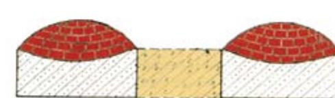
Рис. 3. Технология разработки с закладкой пустот разнoprочными смесями при плоской кровле: 6-закладка малой прочности
